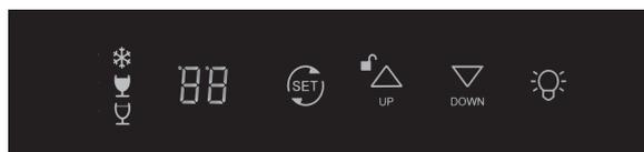
UPボタンを長押しすると、ロックが解除され、温度設定ボタンの上げ下げができるようになります。
