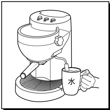
3. 蒸気ノズルを水の入ったカップにひたし、「蒸気調節つまみ」を半回転ほど回して、水蒸気を発生させます。
