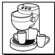
3. 280ccのぬるま湯に対し、大さじ2杯分のクエン酸を溶かし、ウォータータンクに注ぎます。空のカップを2つ用意して、1つのカップをヘッドの下へ、もう一方を蒸気ノズルの下にセットします。
