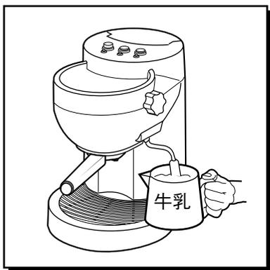
4. 蒸気ノズルを牛乳の入ったカップにひたし、「蒸気調節つまみ」を回して、牛乳を泡立てます。
