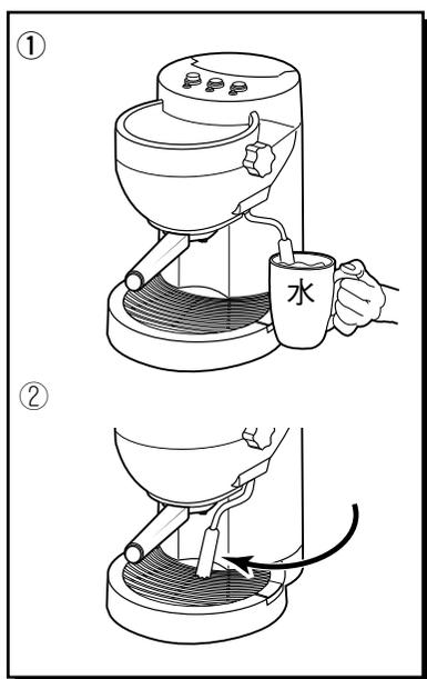
6. ① 温かいうちに、もう一度水の入ったカップを蒸気ノズルにセットし「蒸気調節つまみ」を全開にして、ノズル内に付着したミルクを取り除きます。
