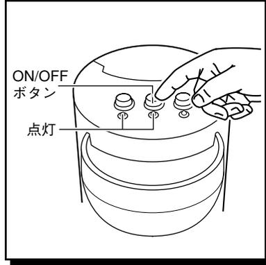
8. <sup>スチーム</sup>「STEAM」ボタンが押されていないことを確認して、「ON/OFFボタン」を押すと電源が入ります。電源表示ランプとエスプレッソ表示ランプの両方が点灯します。
