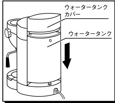
1. 本体にウォータータンクとウォータータンクカバーをセットします。
