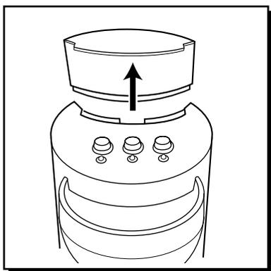
5. ウォータータンクカバーを矢印の方向に取り外します。
