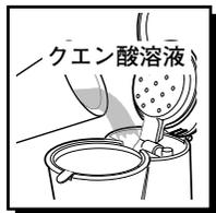
1. 280ccのぬるま湯に対し、大さじ2杯分のクエン酸を溶かし、ウォータータンクに注ぎます。サーモマグをベースプレート上にセットして、STARTスイッチを押します。(コーヒーは入れずに抽出操作をします。)
